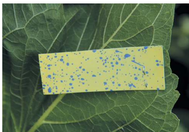
Качество покрытия нижней стороны листьев подсолнечника рабочим раствором при использовании Dropleg UL
