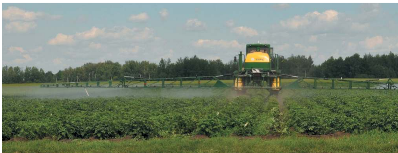
Снос при использовании разных типов форсунок. Слева на штанге щелевые форсунки ST со сносом, справа инжекторные IDKT без сноса рабочего раствора
