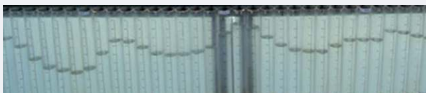
Распределение рабочего раствора через каждые 5 см. Изношенные форсунки
