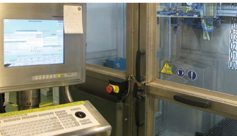
Лабораторное оборудование для моделирования различных условий опрыскивания — скорости, давления, типа распылителей (увы, учесть погодные условия на нем невозможно)
