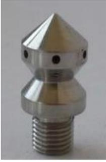
Форсунка обеспечивает очистку внутри трубы, перемещая себя посредством распыления твердых струй в разных направлениях.
