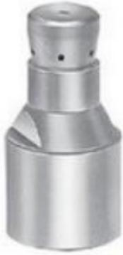
Конструкция форсунки специально разработана для очистки труб. Отверстия (А) расположены под углом в 10°, что обеспечивают продвижение форсунки по трубе и вывод остатков загрязнений. Рабочее давление определяется характером загрязнения и варьируется в диапазоне от 20 до 345 бар.
